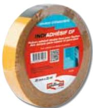
Ruban adhésif double face pour fixation des écrans pare-vapeur et pare-pluie • 25 mm x 25 m • Fixation des pare-vapeur, même fabriqués avec du Tyvek® • Fixation permanente sur des montants en fer ou en bois • Utilisation en intérieur et extérieur • Coloris : Transparent • Température d'application : De - 10°C à + 40°C • Matériaux : Ruban de transfert acrylique d'épaisseur 200 microns, renforcé par une grille polyester, enduit d'un adhésif acrylique • Fiche technique : 10.253
